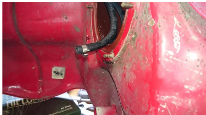
Bild 5: Schelle mit Hakenrastung
