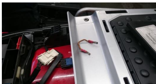
Bild 3: Brücke, um die Benzinpumpenrelais kurzzuschließen
