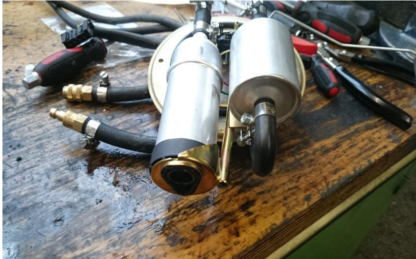
Bild 7: Benzinpumpe und Filter ausgebaut
