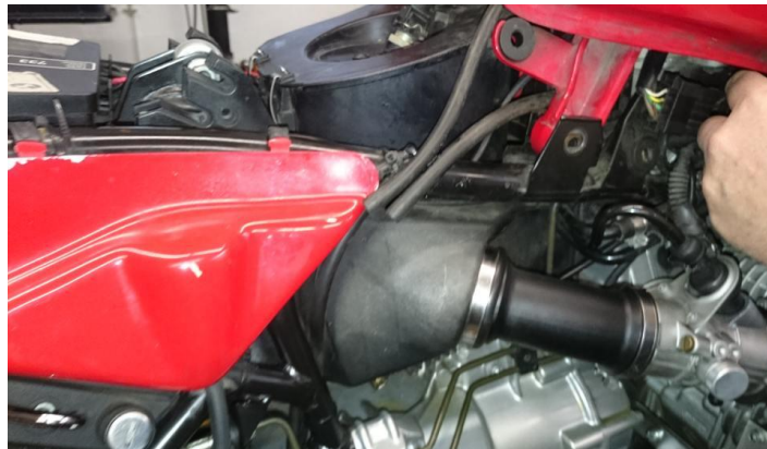
Bild 2: Lüftungs- und Überlaufschläuche abziehen
