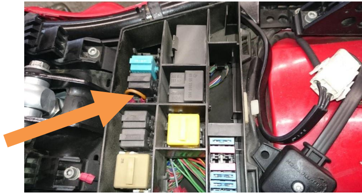
Bild 4: Brücke reinstecken, um Relais zu überbrücken
